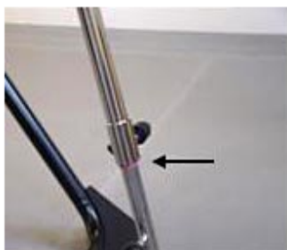
Abb. 6: Die Markierung, die angibt, wie weit das Stützbein ausgezogen werden muss, um einen Neigungswinkel von 5 ° zu erhalten.
